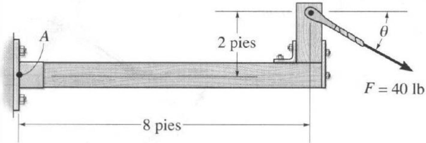
*Rpta.: El momento máximo y mínimo respecto al punto A se obtiene con una dirección igual a  $75.964^\circ$  y  $165.964^\circ$ , respectivamente.*
