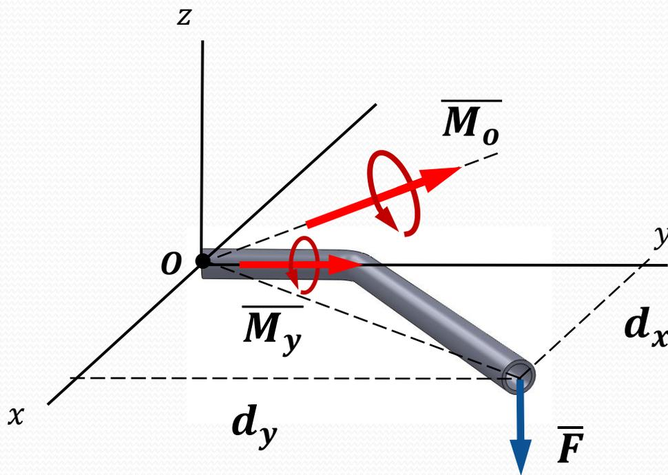
En general, si la **línea de acción** de una fuerza es **perpendicular** a cualquier **eje específico**  $a - a$ , entonces
