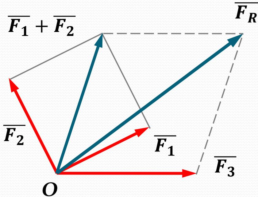
$$\overline{F_R} = (\overline{F_1} + \overline{F_2}) + \overline{F_3}$$
