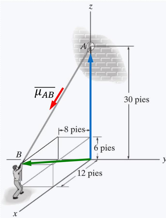
Determinar el vector unitario  $\overline{\mu}_{AB} = \frac{\overline{r}_{AB}}{|\overline{r}_{AB}|}$
