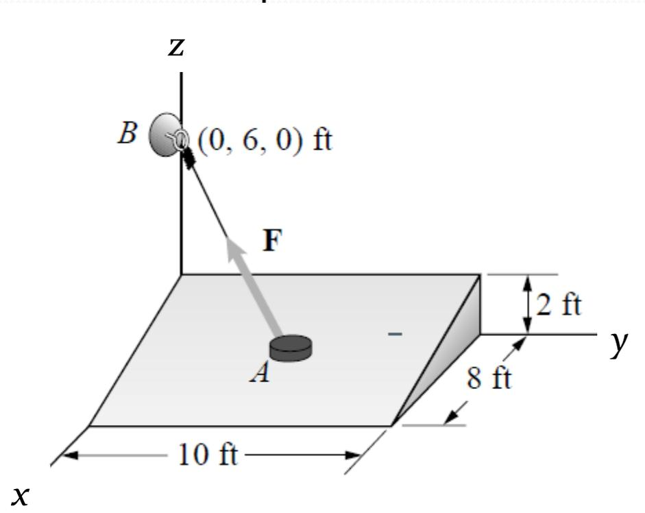
El disco A está en el punto medio de la superficie inclinada. La cuerda de A hacia B ejerce 0.2 lb de fuerza  $F$  sobre el disco. Si se expresa  $F$  en términos de componentes de vector paralelo y perpendicular a la superficie, cual es la componente perpendicular a la superficie?
