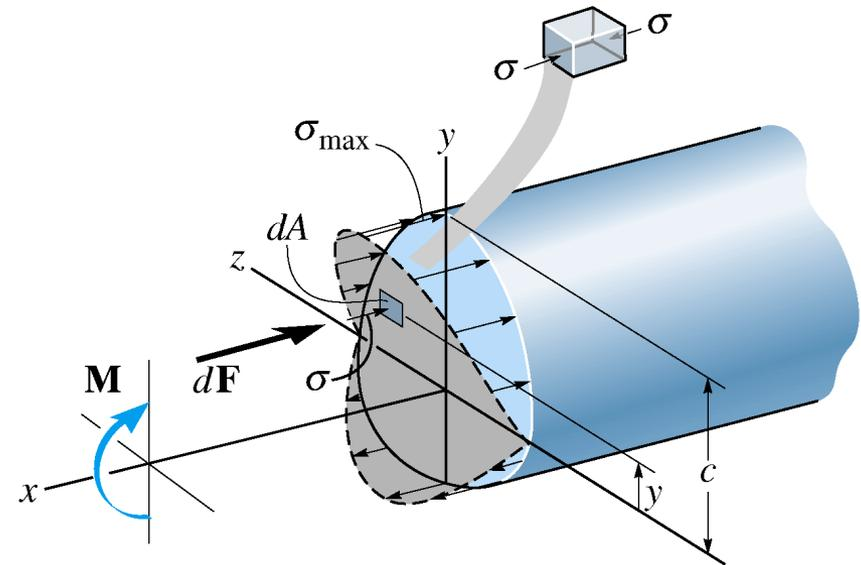
Esta condición puede ser satisfecha sólo si el **eje neutro** es el **eje centroidal** horizontal de la sección transversal.
