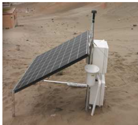
Magnetómetro del INRAS – PUCP, instrumento que mide las variaciones locales del campo magnético, instrumento principal del proyecto PERÚ-MAGNETO
