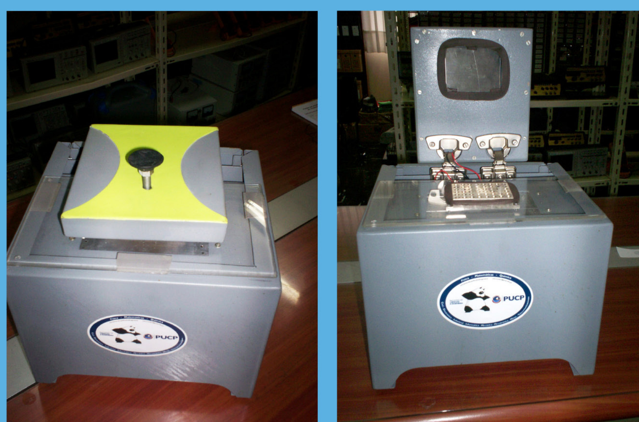
Las figuras presentan al prototipo desarrollado: Termociclador – PUCP a la izquierda cerrado con tapa y a la derecha abierto: al centro se puede ver la bandeja donde van las muestras de ADN, que deben pasar por el proceso de RCP.
