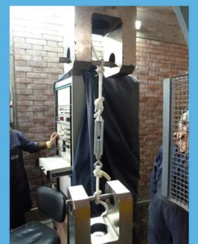
Ensayo de tracción de templador con driza.
