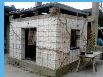
Distribución de reforzamiento con driza en módulo inyectado.
