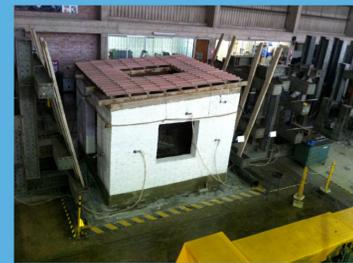
Módulo de adobe a escala natural sin refuerzo antes del ensayo de simulación sísmica.
