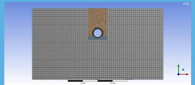
Malla de elementos finitos para el modelo de interacción terreno-tubería. Se aprecia la tubería, la base de concreto, la cobertura de terreno compactado y el terreno natural circundante.
