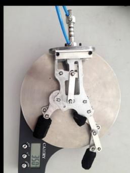
Prototipo de mano tipo pinza fabricado con recubrimiento de caucho en los extremos, en una balanza para medir su peso total.
