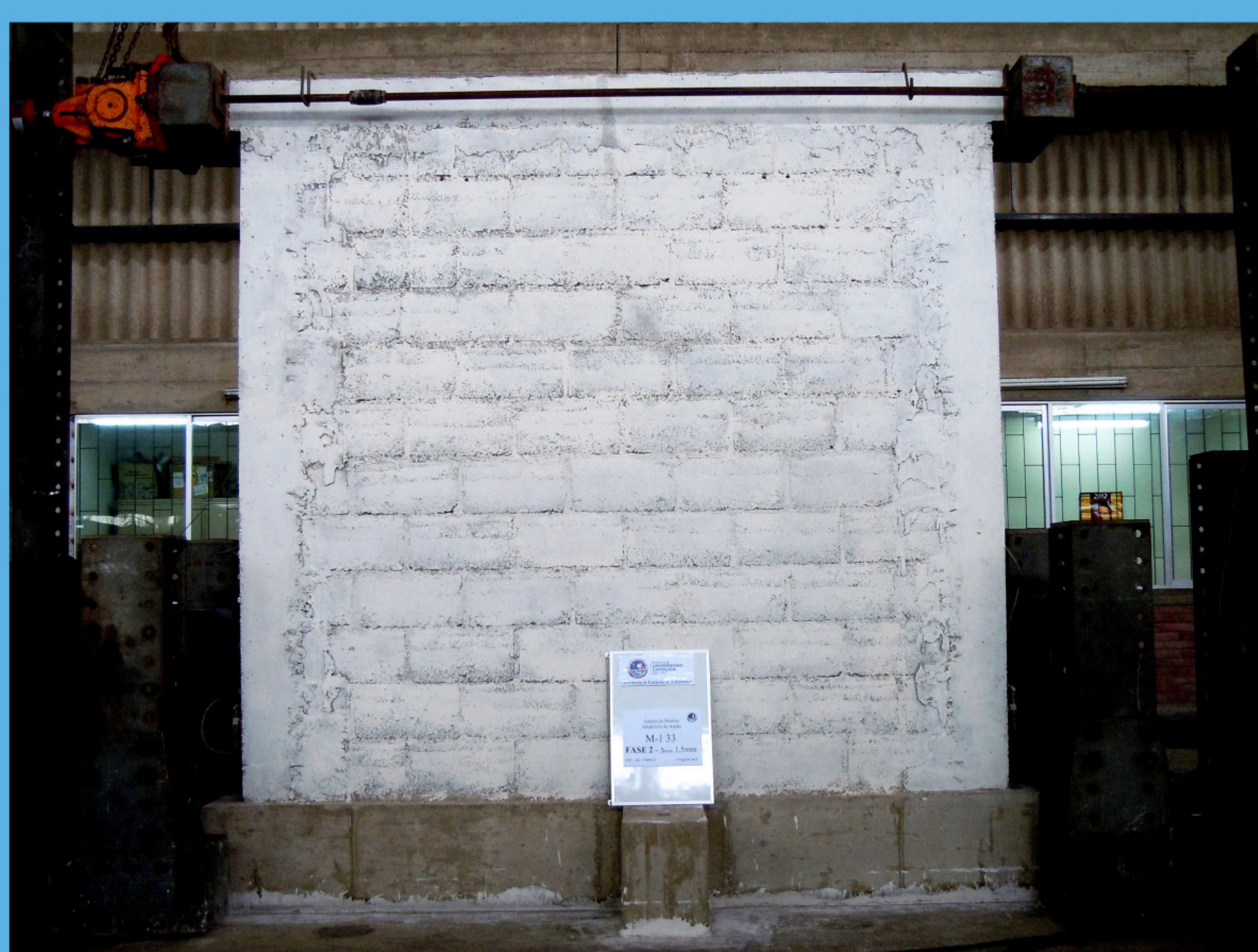
Ensayo de carga lateral cíclica en muro de albañilería confinada mejorada.
