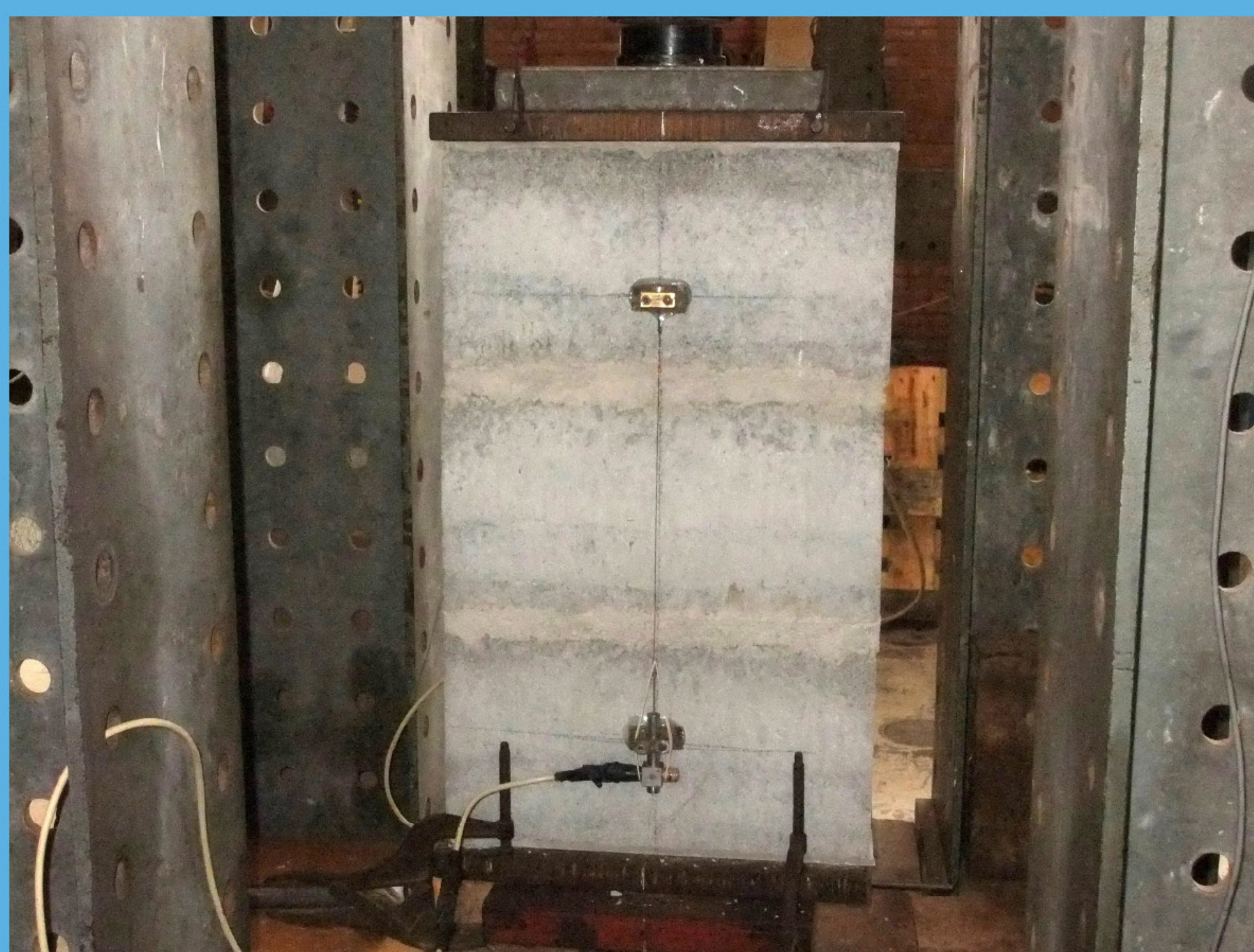
Ensayo de compresión axial en prismas.
