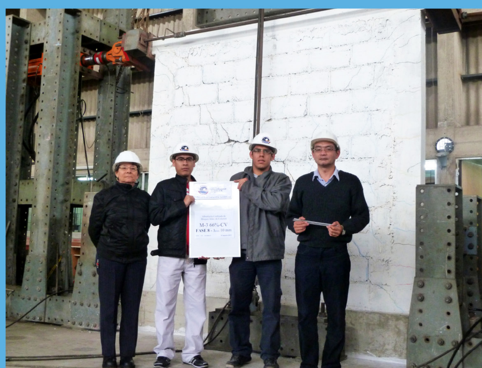
Ensayo de carga lateral cíclica y carga vertical en muro de albañilería confinada mejorada.
