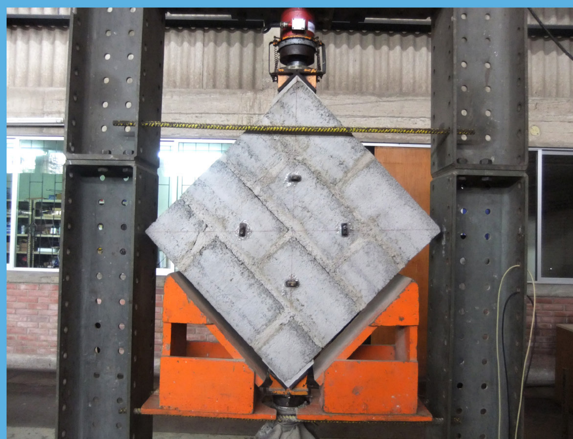
Ensayo de compresión diagonal en muretes.
