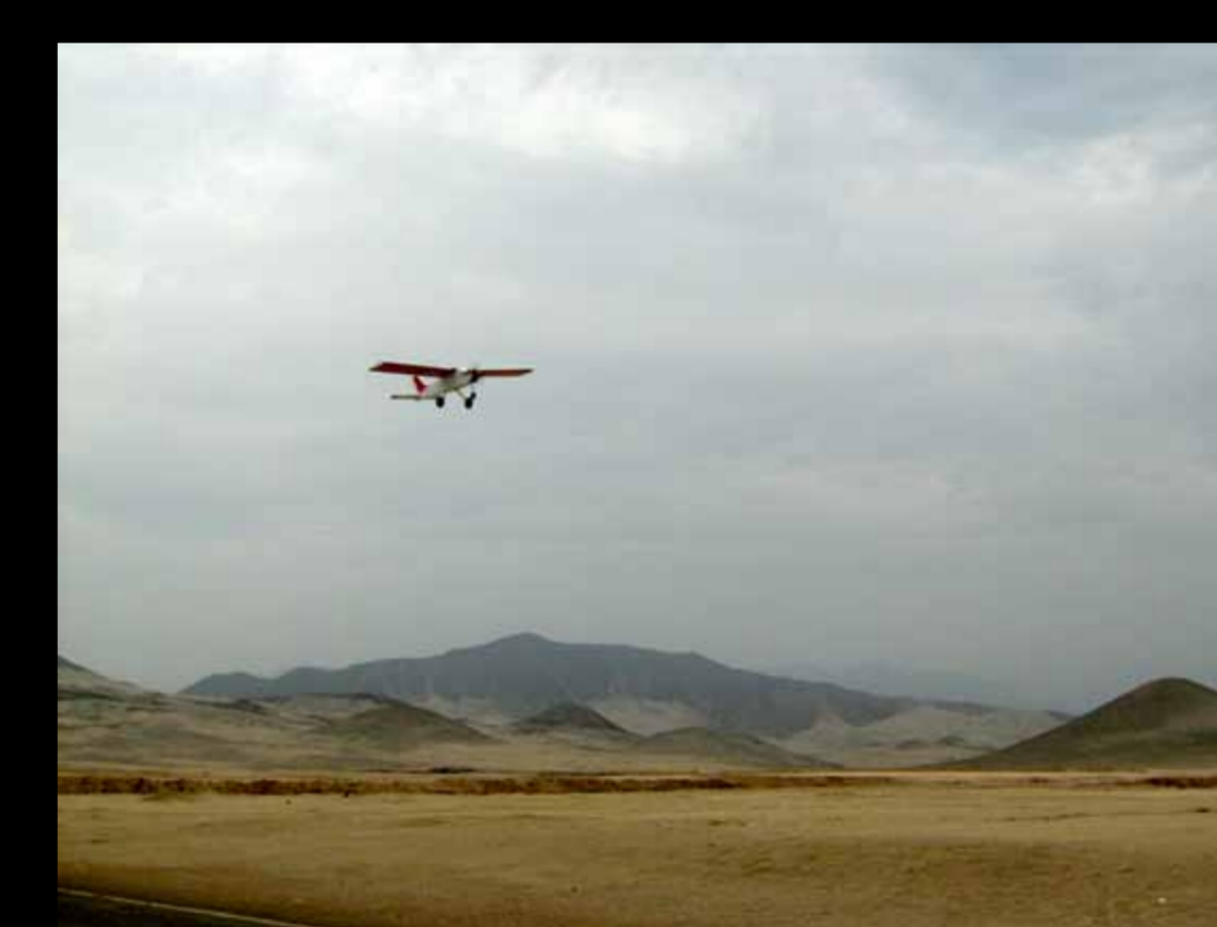
Aeronave no tripulada Squire modificado equipada con cámaras multispectrales despegando para una misión de monitoreo de campos de cultivo.
