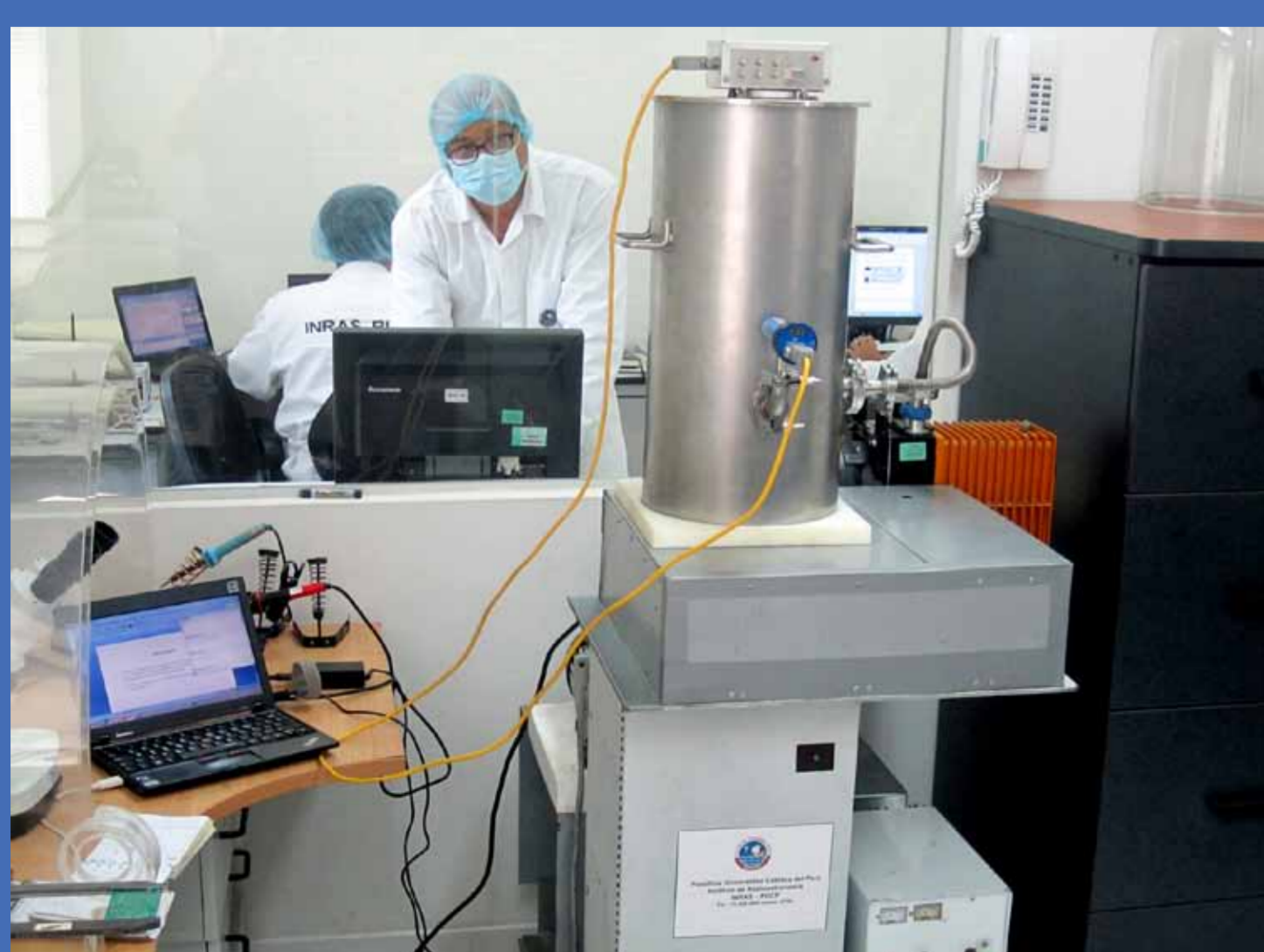
La cámara ambiental y de vacío permite someter a pruebas al satélite PUCP-SAT-1, simulando algunas condiciones críticas del espacio, como la ausencia de transferencia de calor por convección. La cámara lleva al satélite desde -40°C hasta 85°C y bajo presiones de 60 mTorr, fue diseñada y construida por testistas de ingeniería electrónica en el INRAS.
