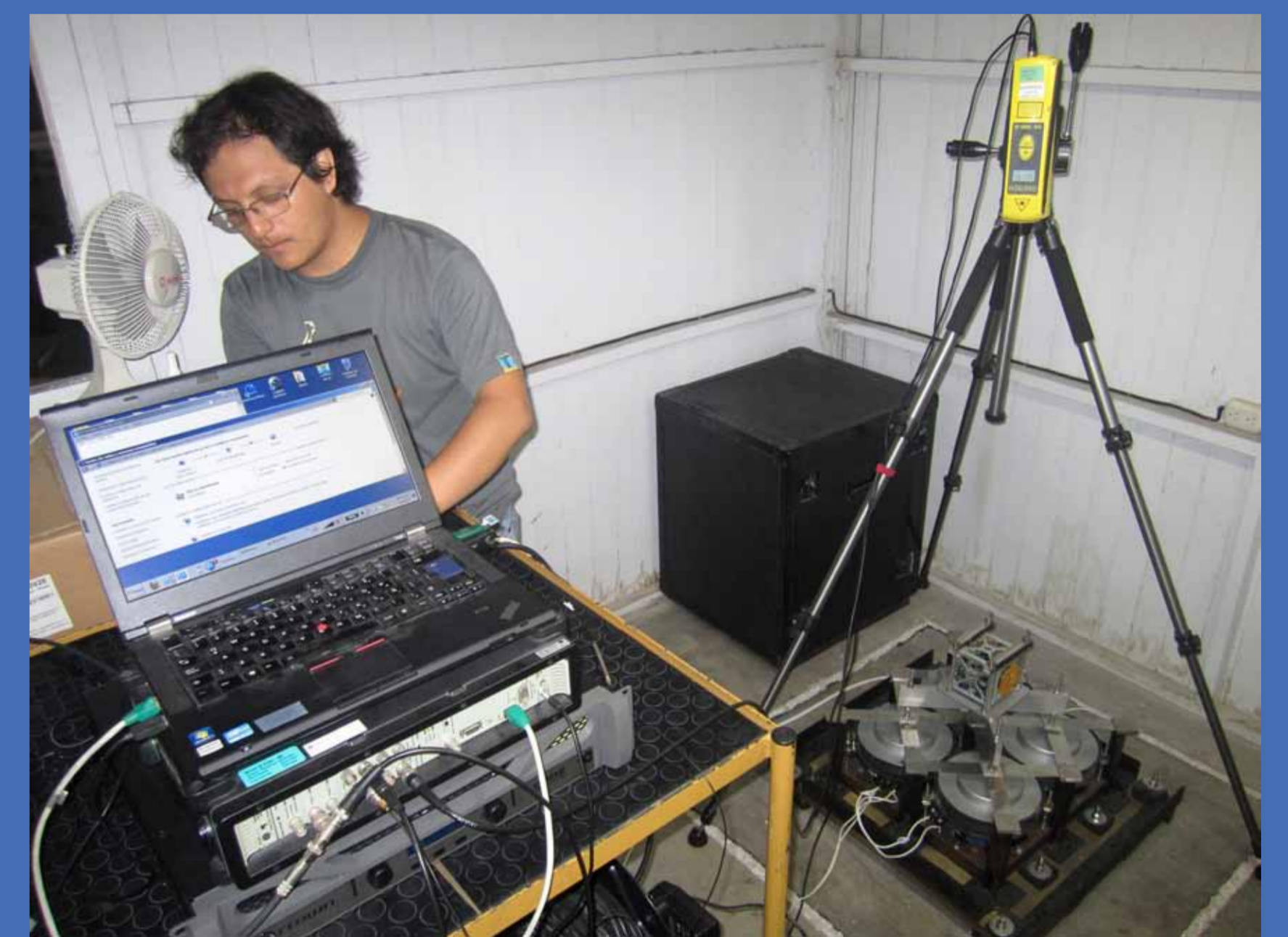
Victor Centa, prepara la máquina de vibración en el INRAS, para una prueba del satélite. El satélite debe ser probado en condiciones de aceleración hasta 9 g, siguiendo un protocolo de pruebas, dado por las características del cohete de lanzamiento.
