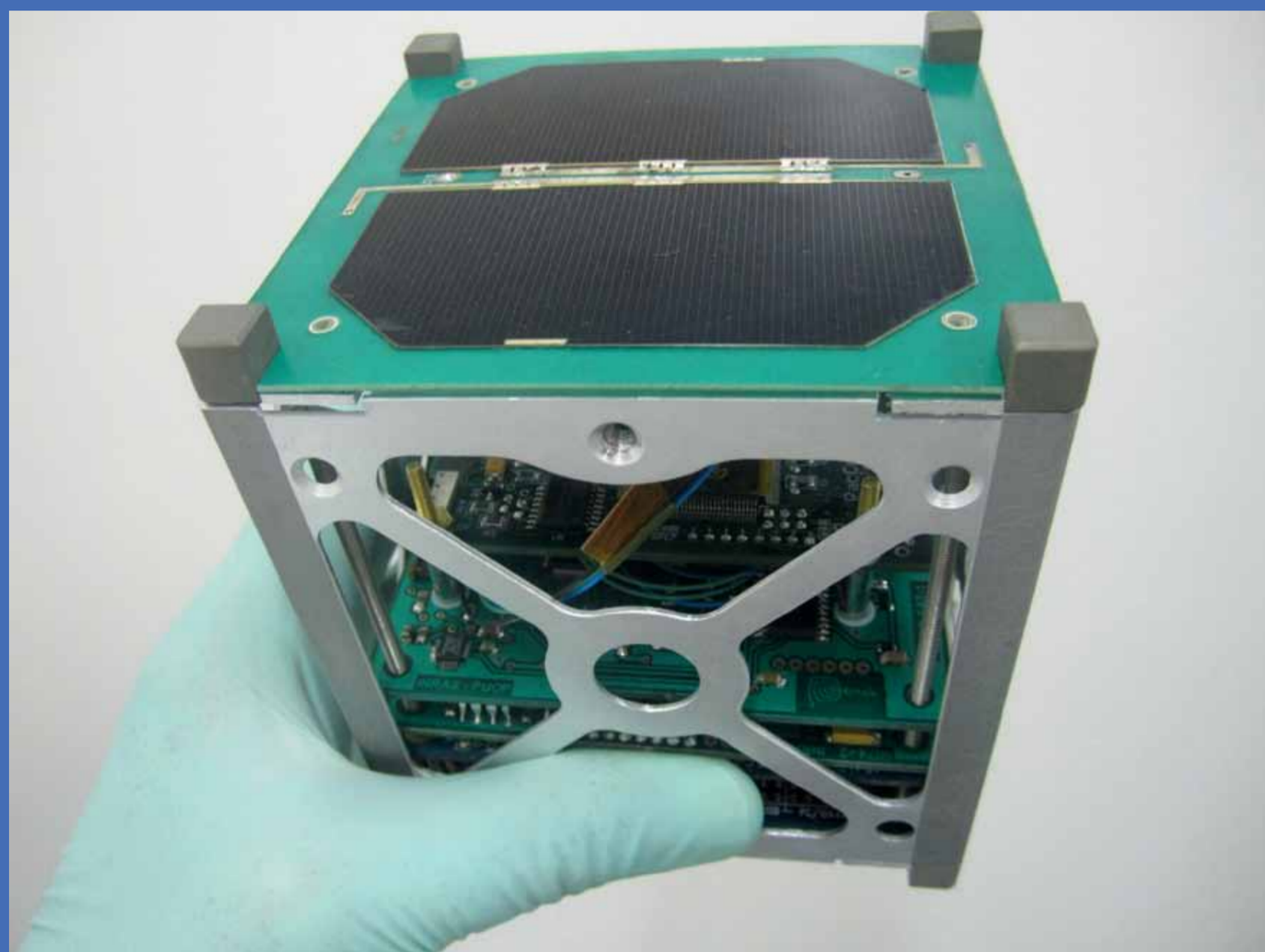
El satélite PUCP-SAT-1 mostrando sus celdas solares.
