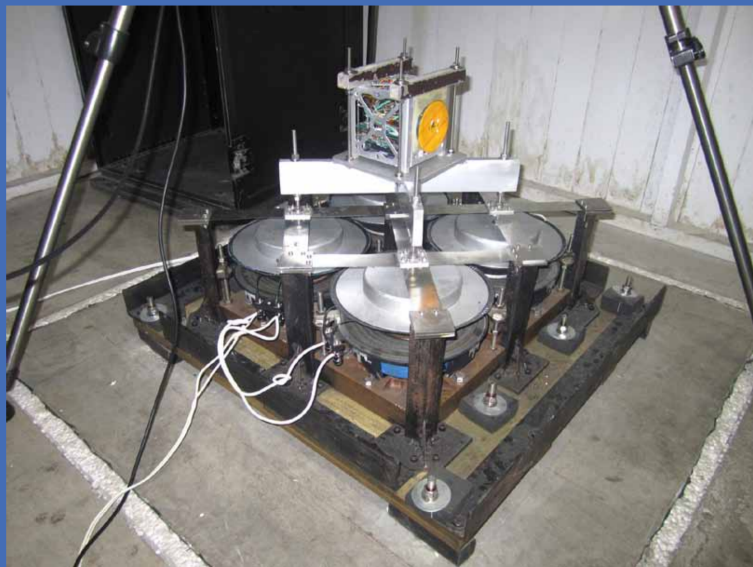
El satélite PUCP-SAT-1 en pleno proceso de pruebas de vibración en la máquina construida en el INRAS-PUCP.
