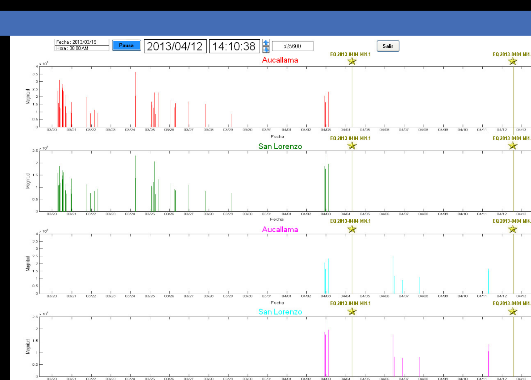
Pulsos recibidos simultáneamente en Aucallama y San Lorenzo, hasta la llegada del sismo (estrella amarilla).
