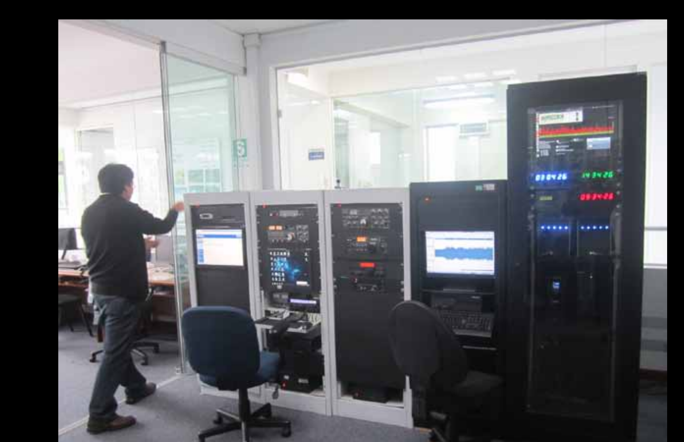
Equipos en el INRAS, donde se reciben los datos de los 10 magnetómetros instalados en la red PERÚ-MAGNETO en diversos lugares del Perú. El resto de equipos son también para estudiar sismos y además se observa el equipo de tierra para las comunicaciones con el satélite PUCP-SAT-1.
