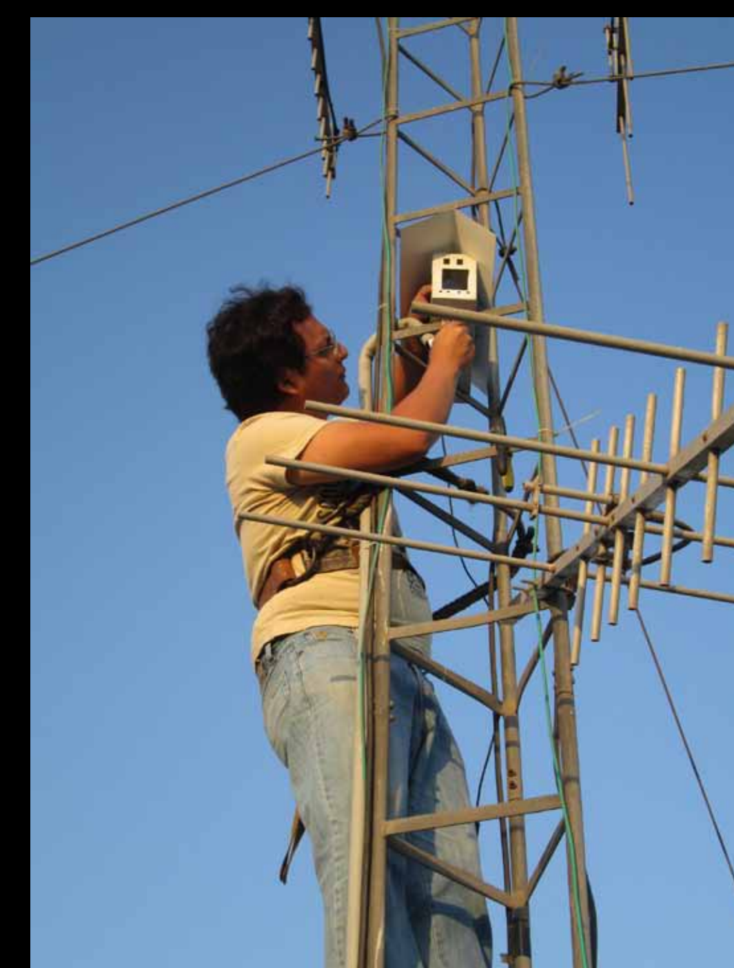
Víctor Centa ajusta una cámara, desarrollada por una tesis, para el reconocimiento automático de luces en el cielo, que podrían ser premonitoras de actividad eléctrica previa a un sismo.
