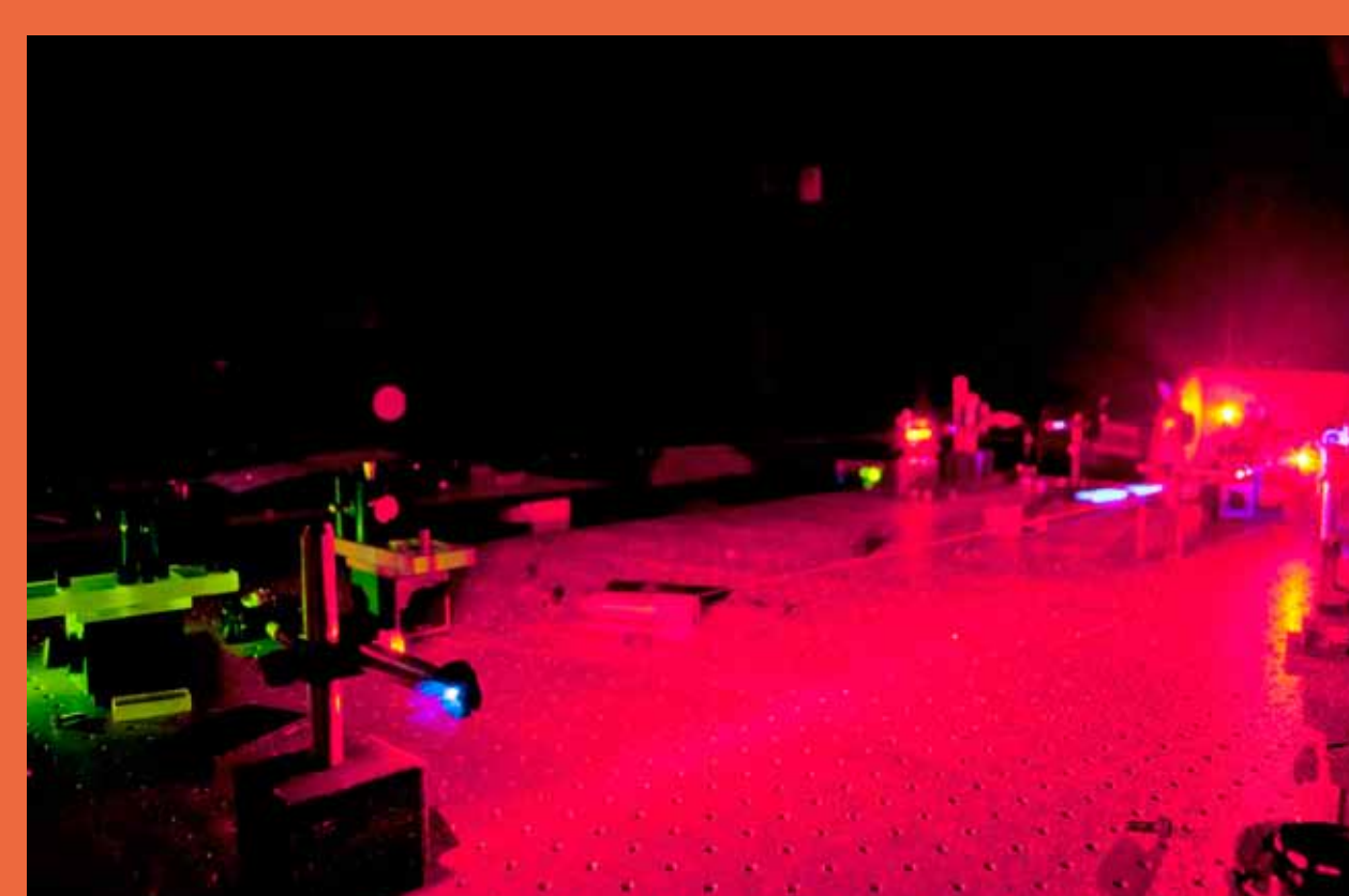
Arreglo interferométrico tipo Mach-Zehnder para medir la fase de Berry. Con tres retardadores en un brazo se genera la fase de Pancharatnam, y con tres retardadores en el otro se anula la fase dinámica.
