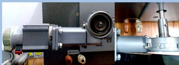
Variac automatizado para el control de corriente de evaporación.
