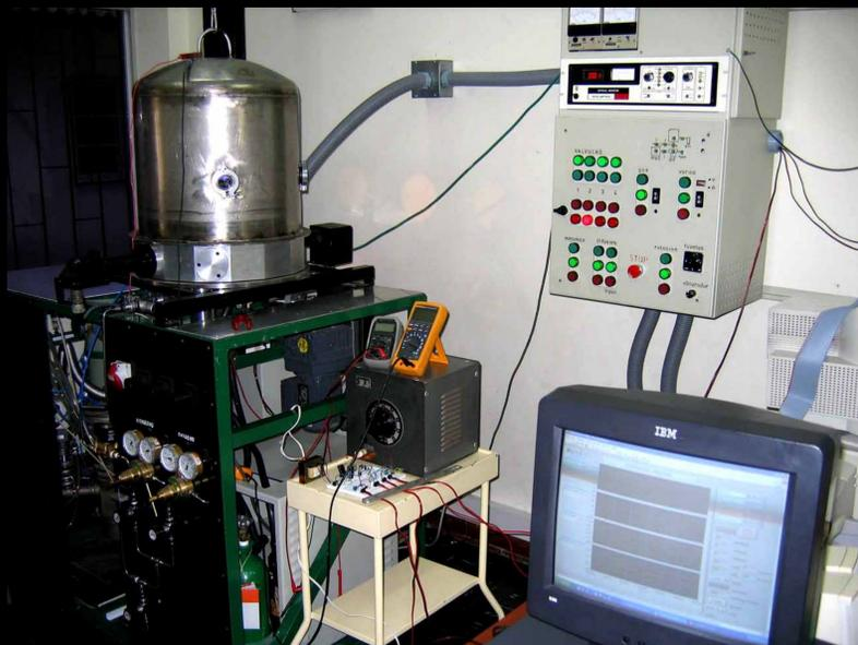
Sistema de control: sistema de manufactura de películas delgadas por evaporación térmica, tablero de control y fuerza, sistema SCADA.
