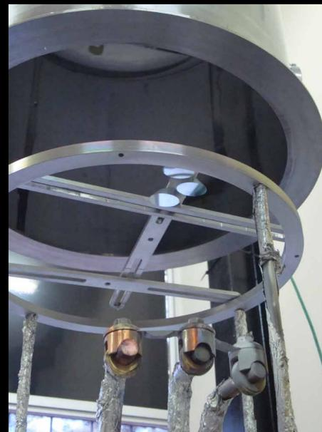
Sistema Planetario (vista superior): soporte de substratos, películas delgadas manufacturadas.
