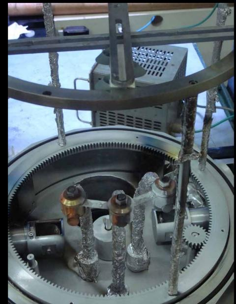
Sistema Planetario (vista inferior): electrodos de corriente y voltaje, fuentes de evaporación, sistema reductor de velocidad.
