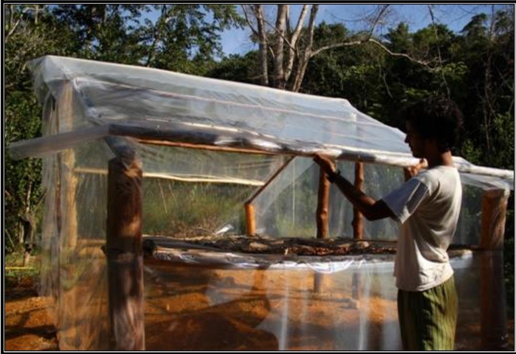
*Demostrando el funcionamiento del secador solar*
