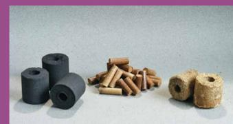
Biocombustibles desarrollados: biobriquetas de aserrín torrefactado, pellets de madera y biobriquetas de cascarilla de café.
