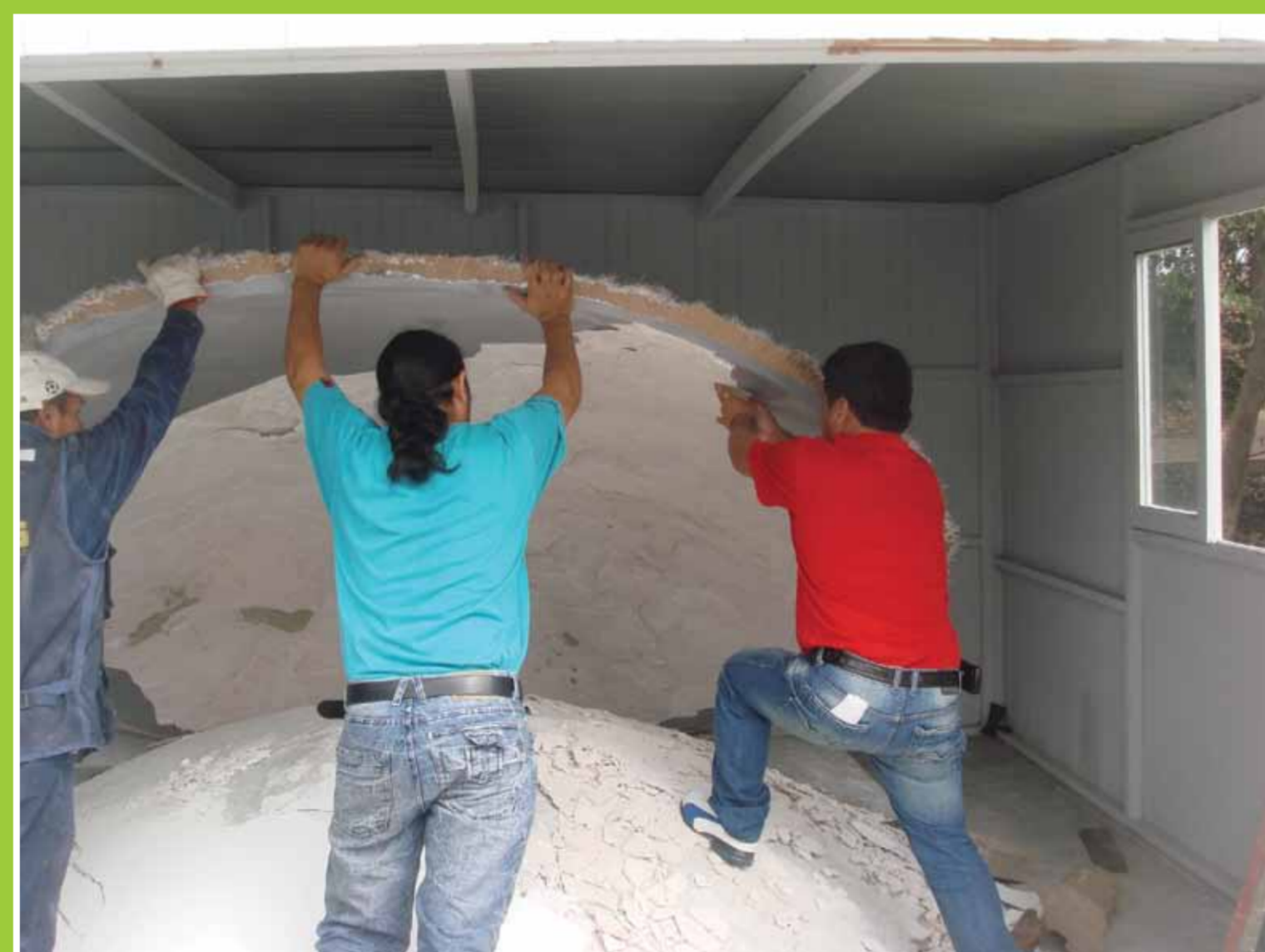
Desmoldando el reflector parabólico
