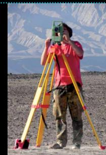
Levantamiento topográfico utilizando una estación total (equipo de la Sección Ingeniería Civil).
