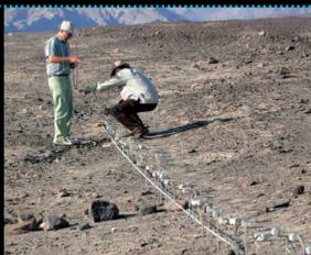
Mediciones eléctricas a través de un Resistivímetro de 4 puntos (equipo de la Universidad de Clausthal-Zellerfeld).
