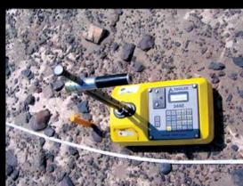
Densímetro nuclear de marca TROXLER (equipo del Laboratorio de Mecánica de Suelos).
