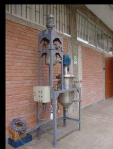
FIG 3. Presenta el Módulo Piloto construido de acero inoxidable.
