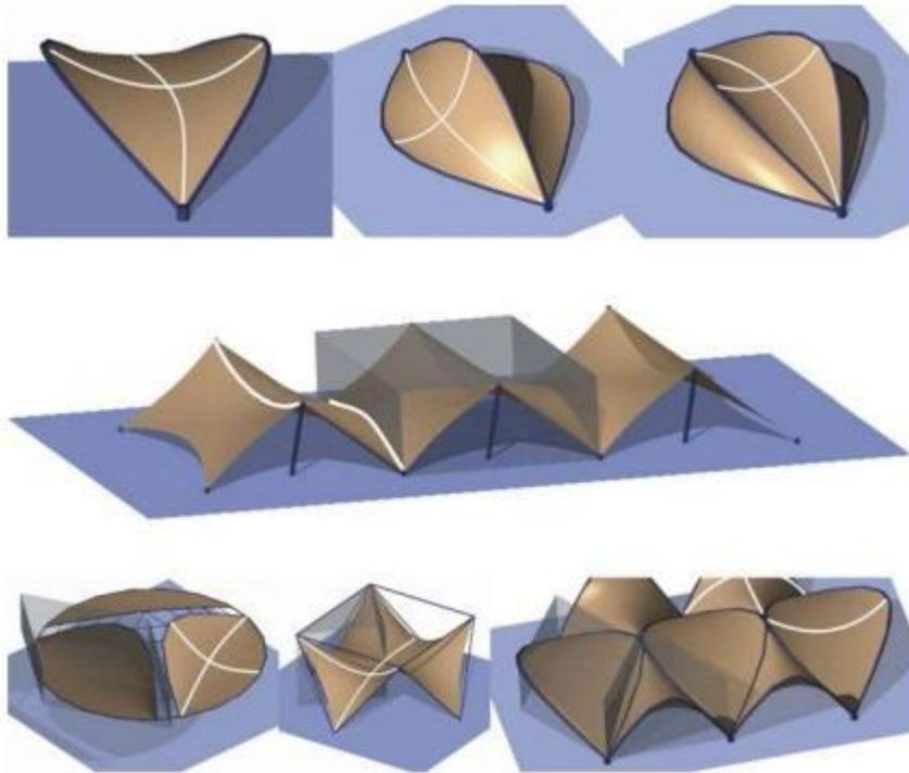
Figura 5: La forma de las cubiertas de membrana; fuente: [www.herrera.unt.edu.ar/revistacet/anteriores/Nro26/PDF/p50-54.pdf](http://www.herrera.unt.edu.ar/revistacet/anteriores/Nro26/PDF/p50-54.pdf)
