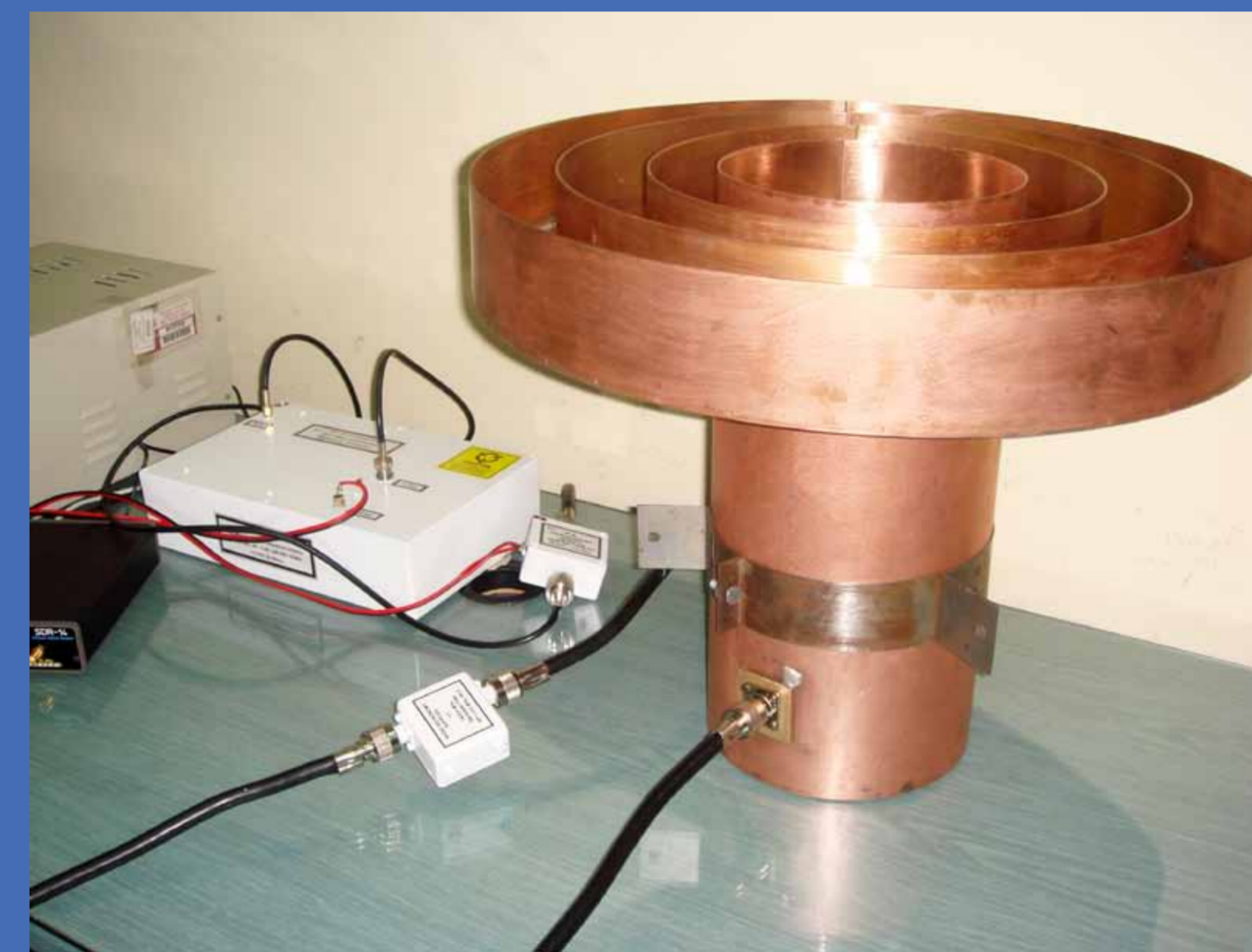
Alimentador para 1.42 GHz, correspondiente a la línea del hidrógeno neutro. Esta será la primera frecuencia de observación por el radiotelescopio.
