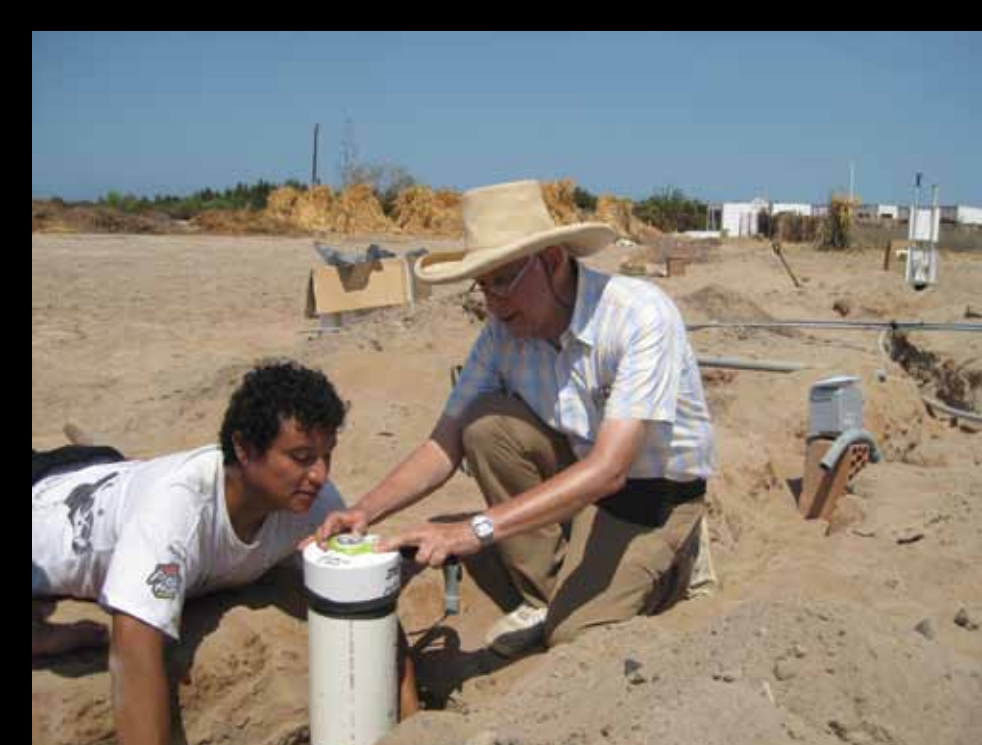
Orientación de una de las bobinas del magnetómetro de Tacna
