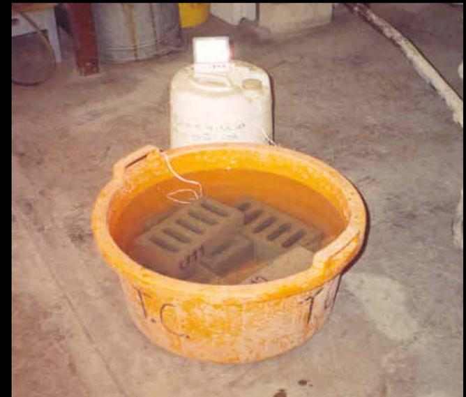
**Para determinar la Absorción Máxima, las unidades deben ser hervidas durante 5 horas para saturarlas completamente.**
