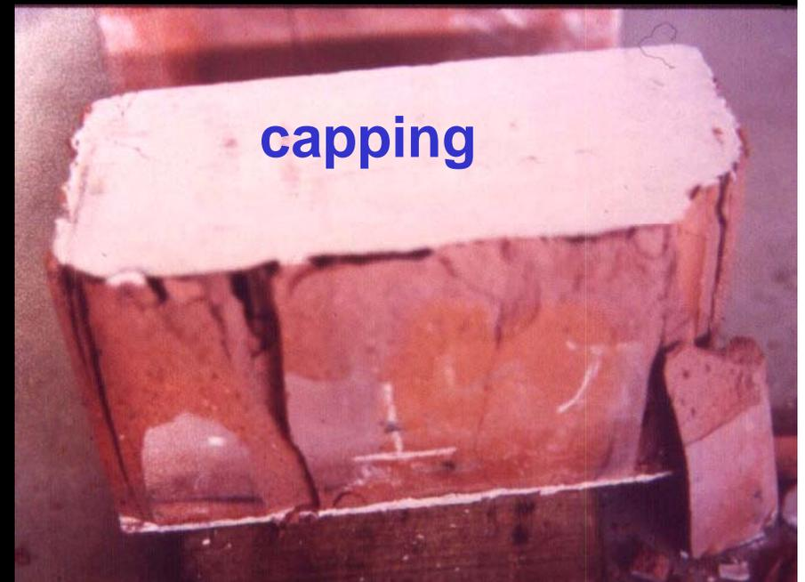
**La resistencia a compresión es sólo un índice de la calidad de la unidad elaborada con la misma geometría y ensayada bajo las mismas condiciones (capping, velocidad de ensayo).**
