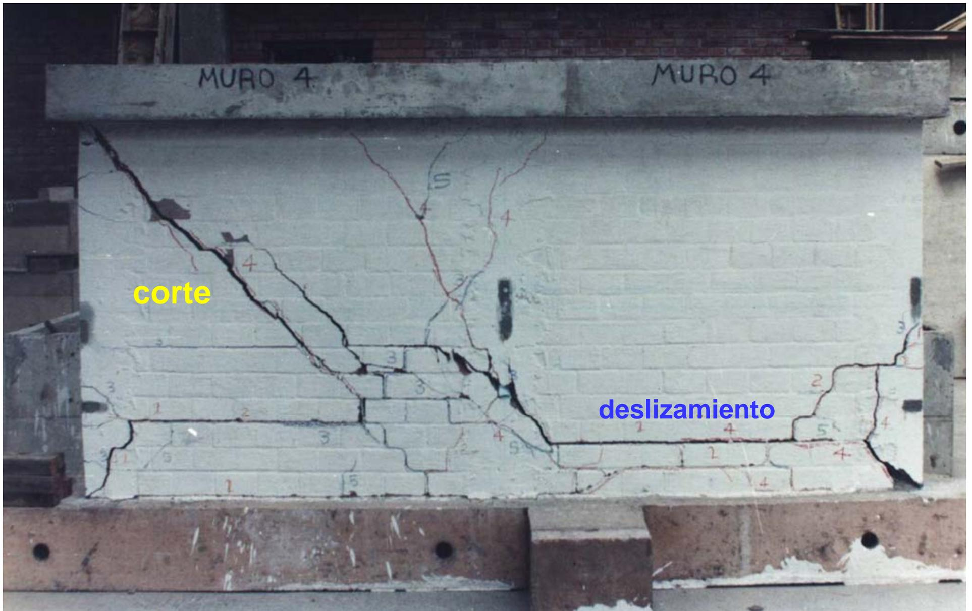
**MURO CONFINADO, FALLA POR CORTE QUE DEGENERÓ EN DESLIZAMIENTO**
