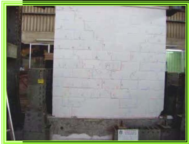
ENSAYOS EN MUROS ARMADOS CON REF. VERT. DISTRIBUIDO (no controlan el corrimiento de la fisura longitudinal producida por flexión)
