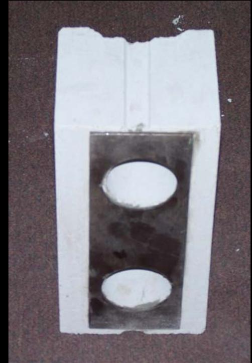
**Cuando se requiere confinar los talones ( $\sigma_u > 0.3f'_m$ ), se usa platinas pegadas con epóxico o espirales (zunchos) discretas**
