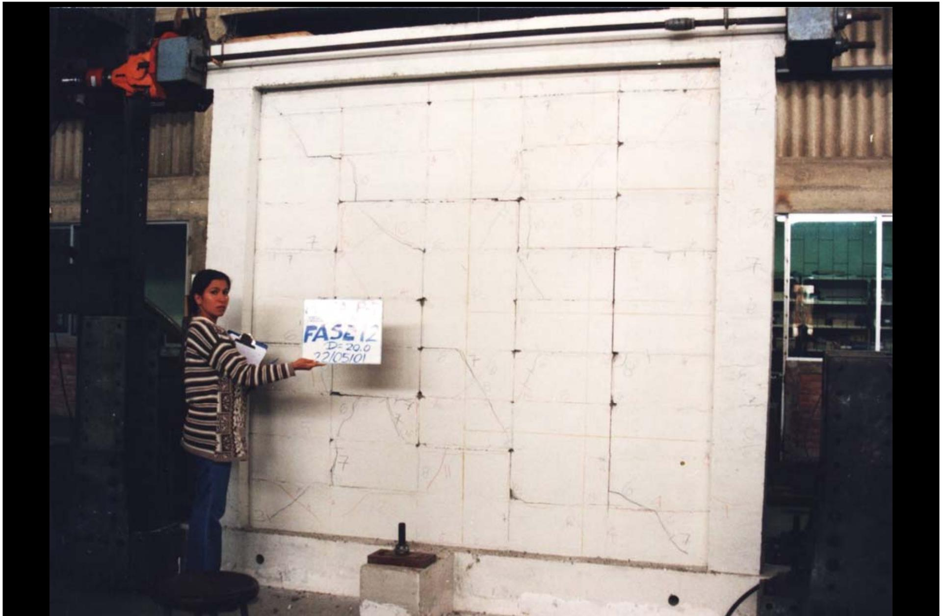
**Ensayo de Carga Lateral Cíclica Coplanar. Deriva = 0.007.**
