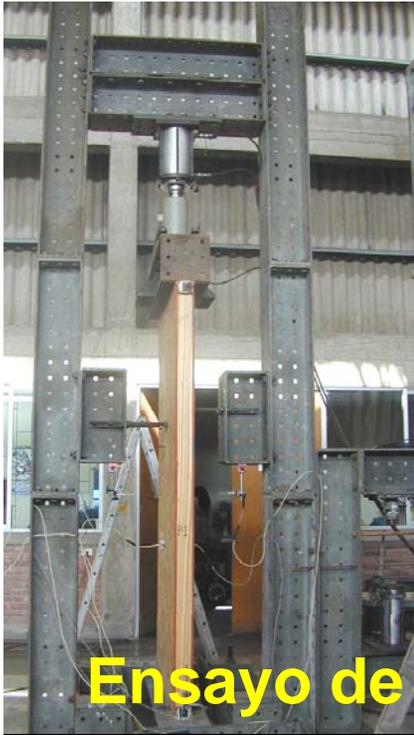
Ensayo de compresión
