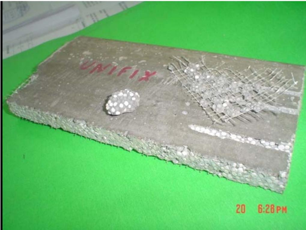
En el PanelCast original se utiliza placas UNIFIX (aglomerado de cemento con bolillas de tecnopor cubierta por geomalla).
