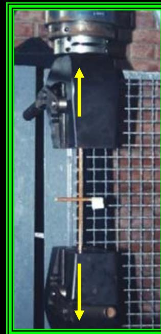
Estas mallas tienen ductilidad reducida en comparación con las varillas convencionales.
