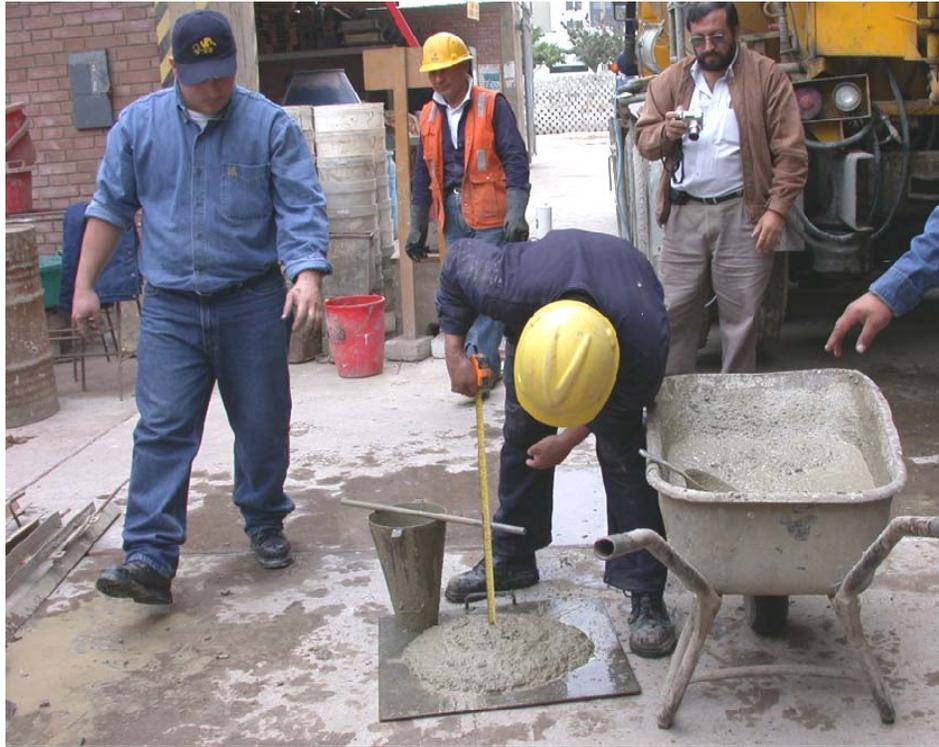
**El concreto que se utiliza es premezclado rheoplástico, con slump = 10" y baja relación a/c  $f'c$  (mín) = 175 kg/cm<sup>2</sup> preparado en Mixer y vaciado con Bomba**
