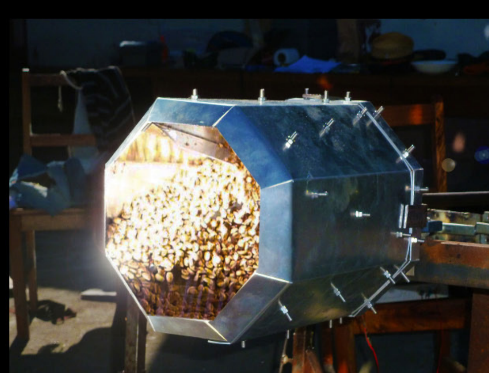
Tostador de café solar funcionando.
