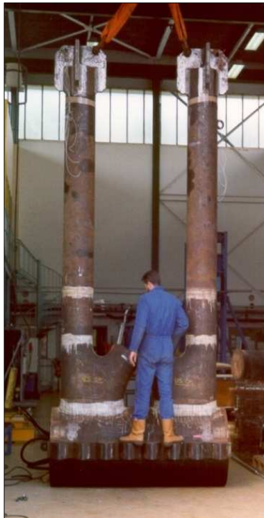
Ensayo de cansancio sobre un elemento de una estructura offshore
