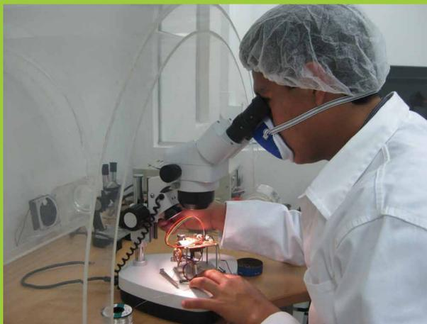
Proceso de montaje superficial en tarjetas electrónicas del picosatélite PUCP-SAT-1
