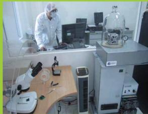
Cámara ambiental para probar termicamente y en vacío el satélite PUCP-SAT-1
