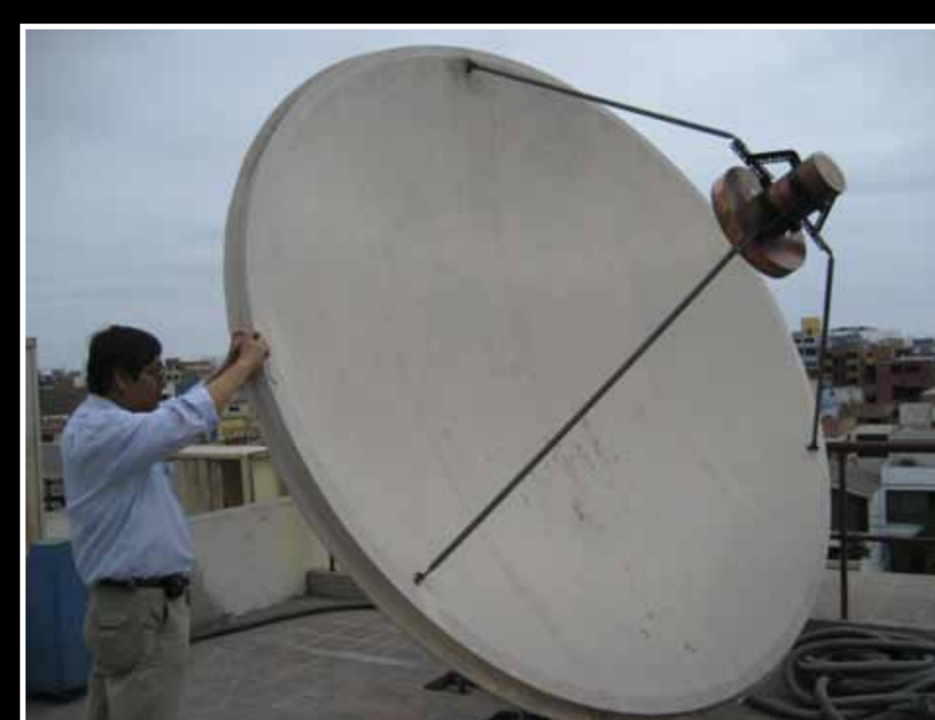
Prueba del aumentador de la RT-20 con una antena de 3m de diámetro
