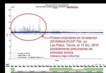
Pulsos del Magnetómetro de Tacna
