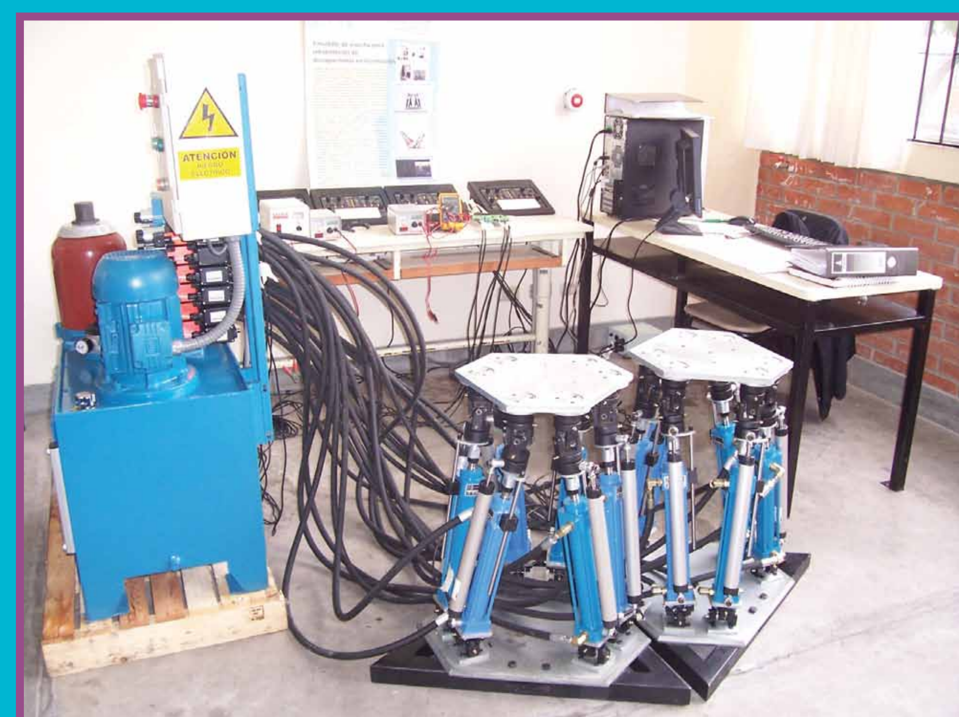
Plataforma con sistema oleohidráulico.
